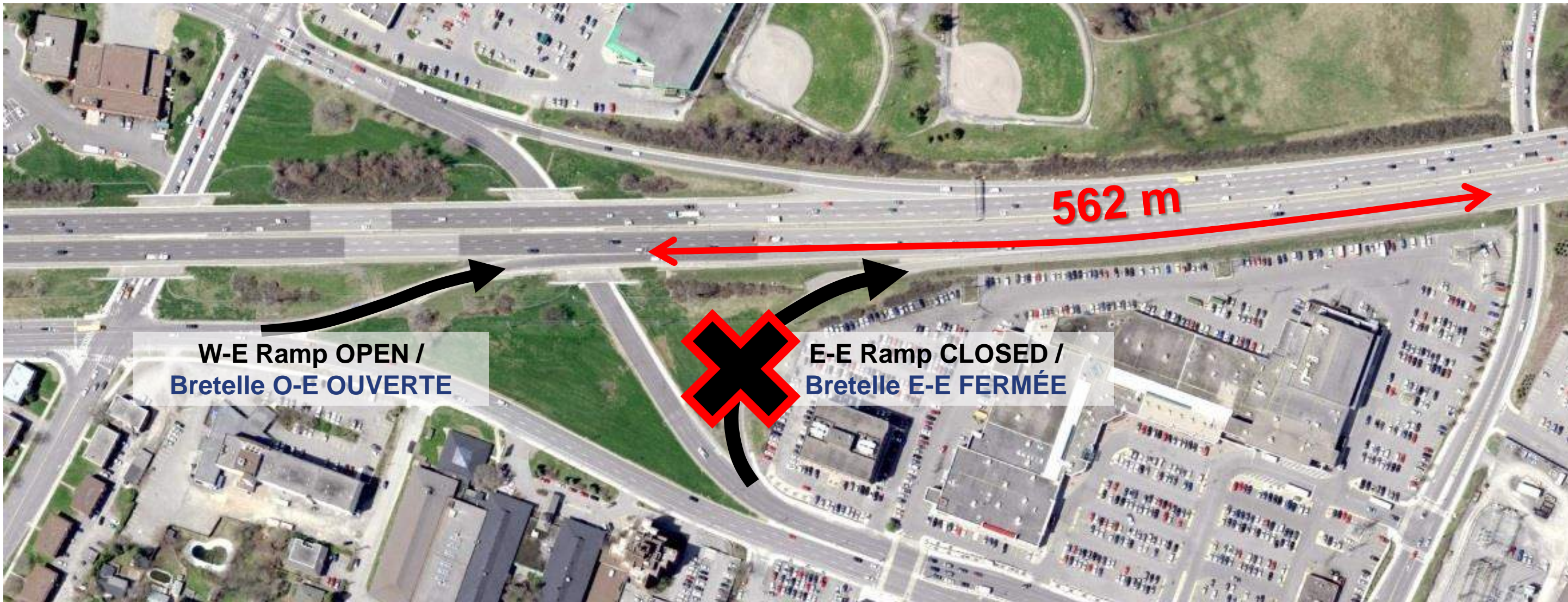
FUTURE WIDENING: W-E RAMP INCREASED ACCELERATION LANE ÉLARGISSEMENT FUTUR: BRETELLE O-E VOIE D'ACCÉLÉRATION PLUS LONGUE
